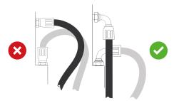
Cotovelos e adaptadores devem ser usados para compensar deformações nos conjuntos, e dar melhores instalações as quais serão mais acessíveis para instalação e manutenção.
